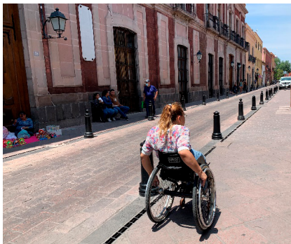
Imagen 18. Textura en pavimentos que inhiba caídas y posibilite la circulación en silla de ruedas
